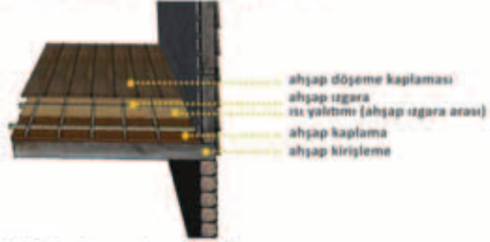
Şekil 16: Ara kat ısı yalıtımı önerisi
