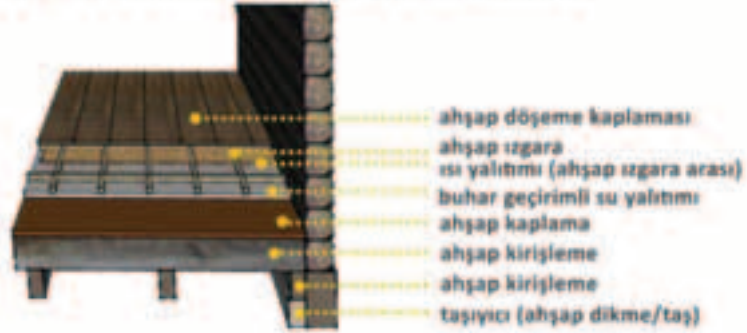
Şekil 14: Zemin kat ısı ve su yalıtımı önerisi
