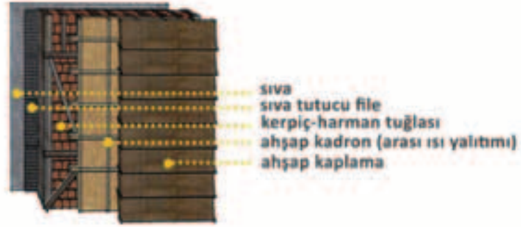
Şekil 9: Tuğla dolgulu ahşap karkas duvarda ısı yalıtım önerileri
