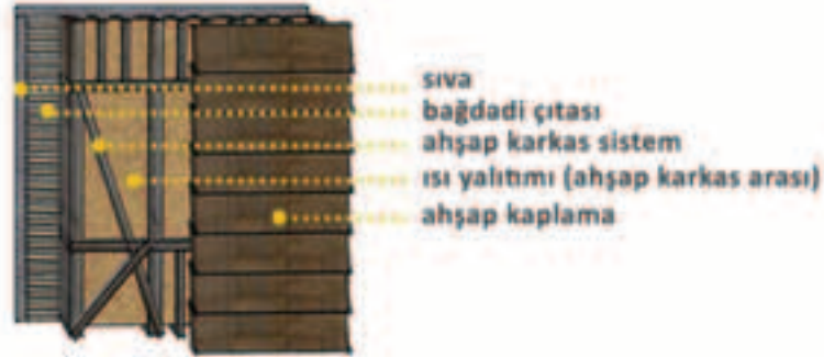
Şekil 9: Tuğla dolgulu ahşap karkas duvarda ısı yalıtım önerileri
