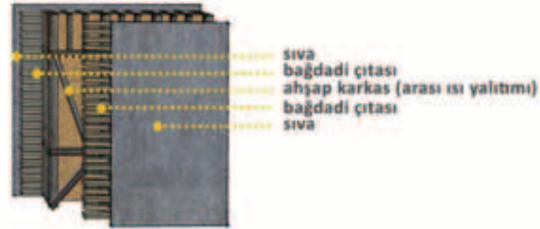
Şekil 10-11: Boşluklu ahşap karkas duvarda ısı yalıtım önerileri
